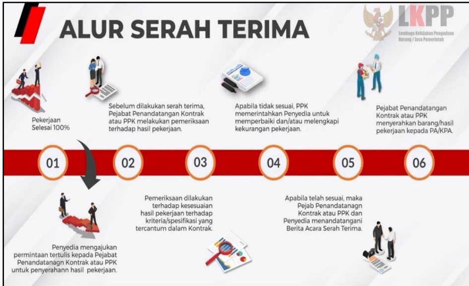
Gambar 2.2 Prosedur Serah Terima Pekerjaan
